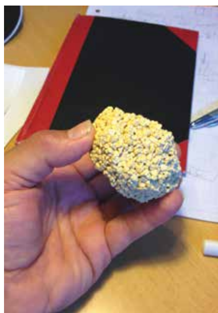
Figur 4. Udfældning af kalk har kittet de enkelte filterkorn sammen i filtermaterialet (Nevtraco®, CaCO 3 ) og reduceret dets porevolumen væsentligt.
